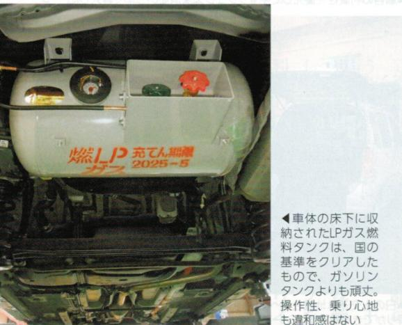
▲車体の床下に収納されたLPGガス燃料タンクは、国の基準をクリアしたもので、ガソリンタンクよりも頑丈。操作性、乗り心地も違和感はない
