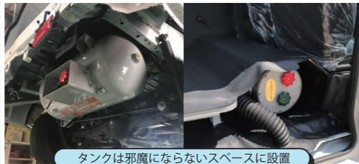
タンクは邪魔にならないスペースに設置
